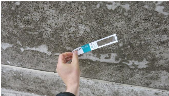
Foto 3. Overflateprøver viser rik vekst av kondensmuggsopper på undersiden av betongdekke og øvre del av yttervegger.
