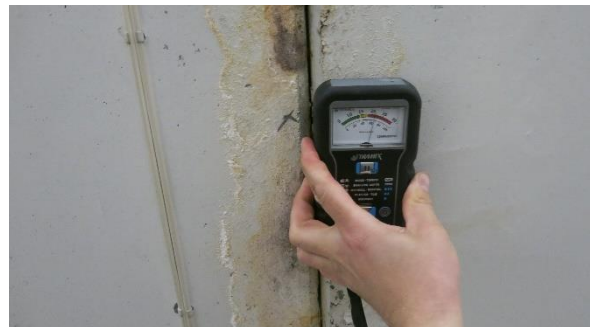
Foto 6. Måling med fuktindikator viser fuktutslag ved fuktmerkene.
