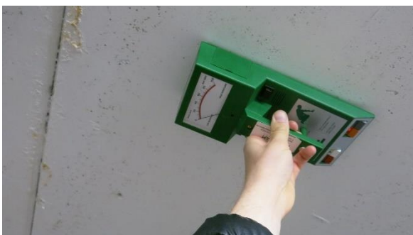
Foto 7. Måling med fuktindikator viser ingen unormal fuktutslag på områder utenom fuktmerkene.
